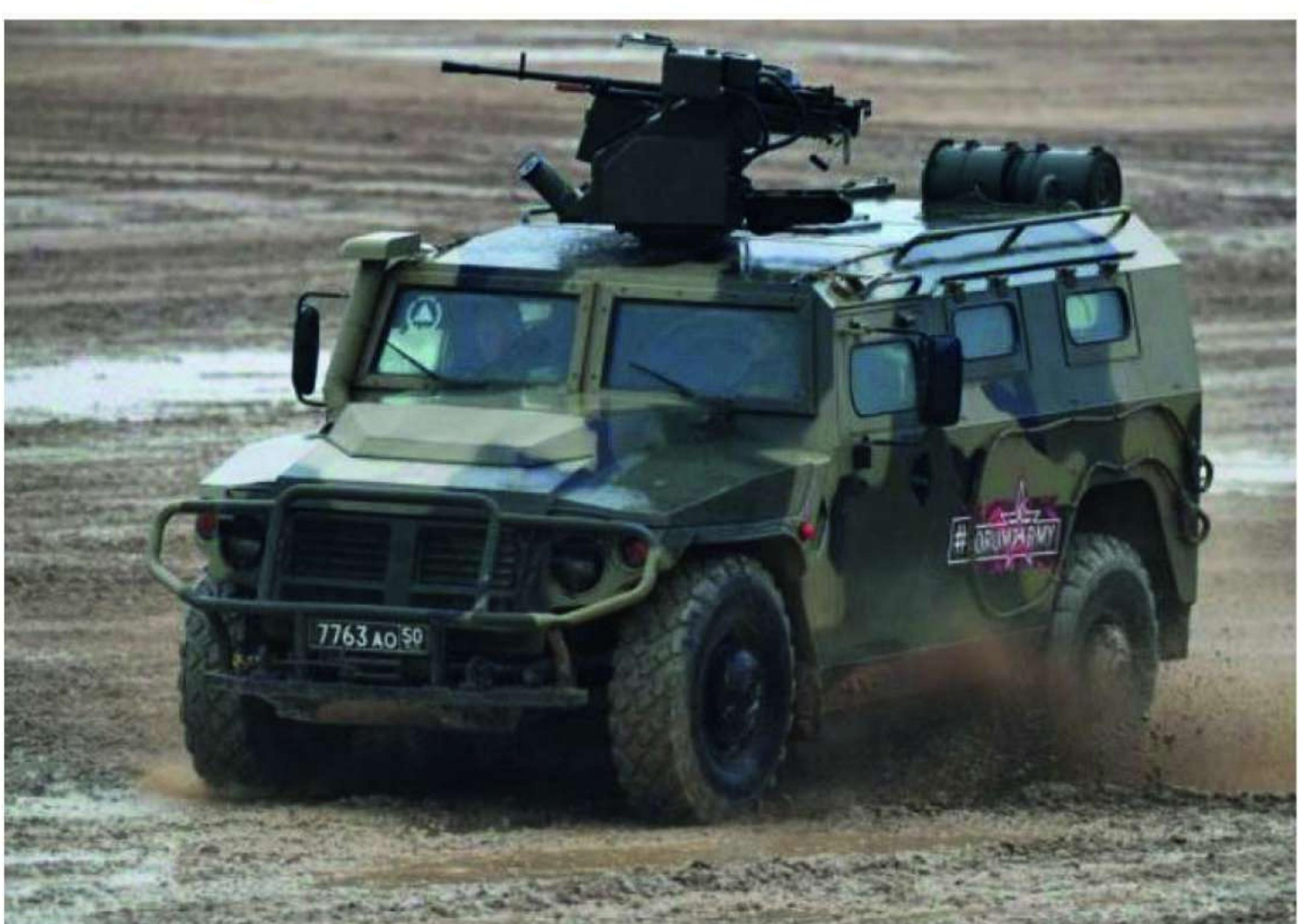
требуемого уровня защиты, буксирования прицепов, монтажа вооружения, военной и специальной техники. В стандартной комплектации оборудованы антитравматическими сиденьями для всех членов экипажа и кондиционером.
