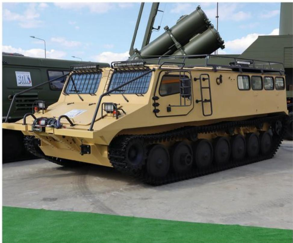
колесная БМП К-17, бронеавтомобиль многоцелевого назначения ВПК-59095С "ВПК - Урал", плавающий гусеничный снегоболотоход 5901 с грузоподъемностью 5 тонн.
