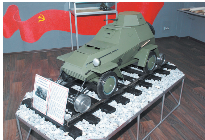
Центральное место в музее занимает модель бронеавтомобиля БА-64В (Выксунский) на железнодорожном ходу, выполненная в масштабе 1:3.
