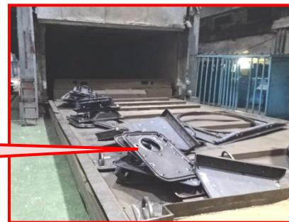
Коэффициент использования рабочего пространства печи до 0,5
