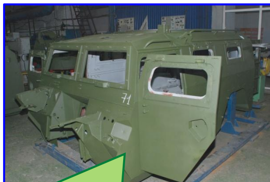
Корпус «Тигр» 233115 При освоении производства изготовлено 73 ед. технологической оснастки.
