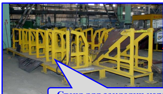
Стенд для закладки корпуса
