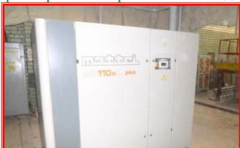
Компрессорная установка «АС-110» (мощность электродвигателя 110кВт/час)
