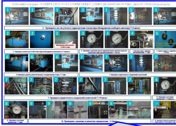
Рабочий стандарт на техническое обслуживание оператором специального горизонтального фрезерно-расточного МСР6401МФ4-04М1
