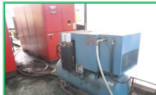
Компрессорная установка «ZENIT» (мощность электродвигателя 5,5 кВт/час)
