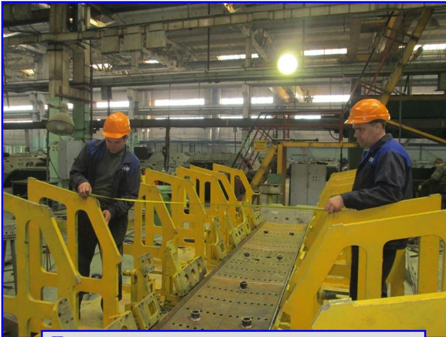
**Проектирование, изготовление, монтаж и нивелировка сложной, крупногабаритной оснастки закладочного стенда с последующим техническим обслуживанием.**
