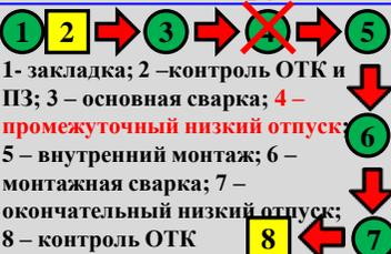
1- закладка; 2 – контроль ОТК и ПЗ; 3 – основная сварка; 4 – промежуточный низкий отпуск; 5 – внутренний монтаж; 6 – монтажная сварка; 7 – окончательный низкий отпуск; 8 – контроль ОТК
