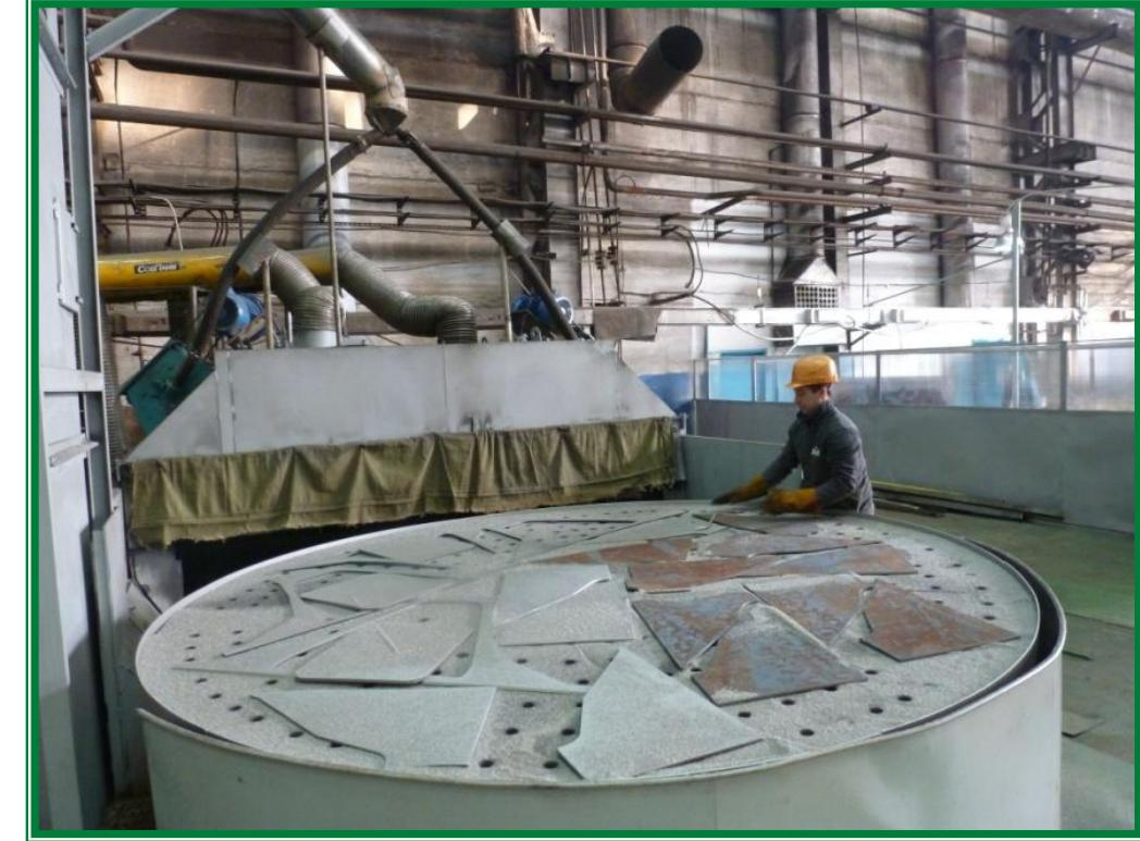
Совместно мастерами производственного и ремонтного персонала реализован проект «Стандартизация процесса дробеструйной очистки деталей». Своими силами разработана, изготовлена и внедрена в эксплуатацию камера для очистки металла от окалины. Себестоимость 0,976 млн. руб., рыночная стоимость у производителя 10,5 млн. руб.
