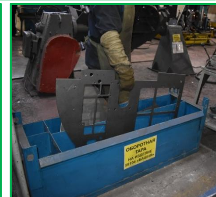
Поставка деталей в рабочую зону оператора. Перекладка исключена
