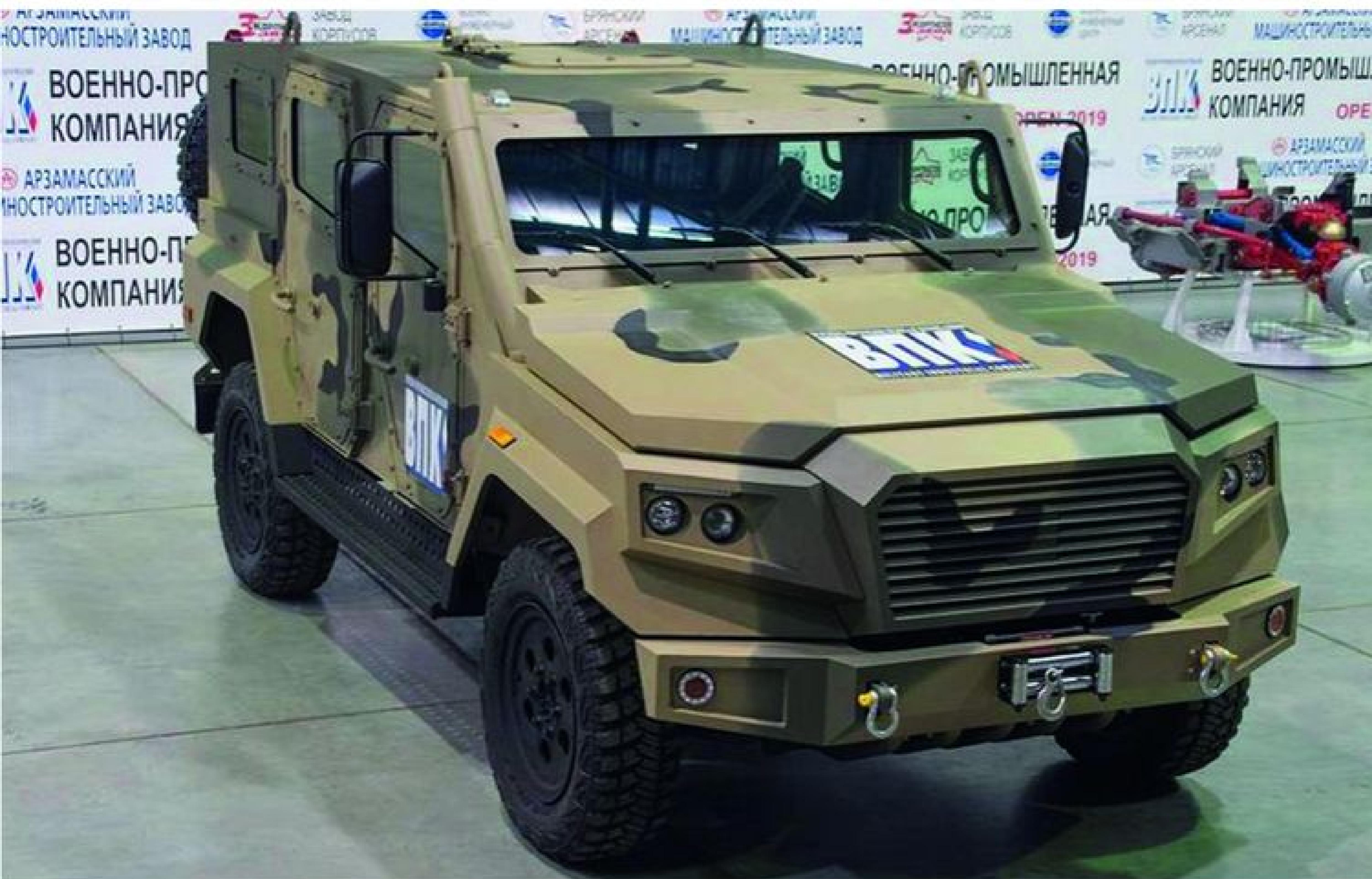
**Специалисты «Военно-промышленной компании» (ООО «ВПК») в инициативном порядке разработали семейство новых легких бронеавтомобилей «ВПК-Стрела», которые можно транспортировать на внешней подвеске вертолета типа Ми-8. Изготовлен первый экспериментальный образец машины.**
