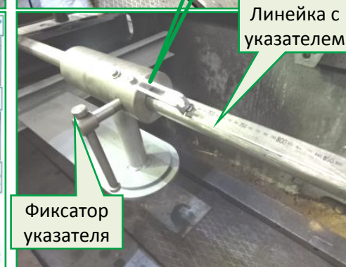
Рабочий стандарт вырезки заготовок на листовых ножницах с использованием упора
