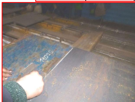
Разметка заготовок универсальным способом
