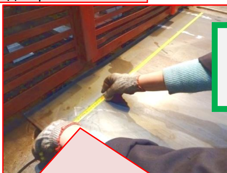
Разметка заготовок универсальным способом
