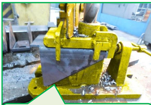
Кондуктор для проведения сверловки деталей
