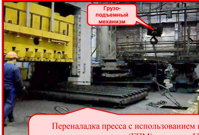
Переналадка пресса с использованием грузо-подъемных механизмов (ГПМ) занимала 55 мин. Все работы, связанные с перемещением заготовки во время переналадки пресса приостановлены.
