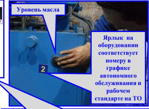
Ярлык на оборудовании соответствует номеру в графике автономного обслуживания и рабочем стандарте
