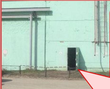
На складе отсутствуют необходимые условия хранения лако-красочных материалов, визуализация на местах хранения тары с ЛКМ. Склад удален от цехов-потребителей на 1,5 км. Нет средств механизации труда, в процессе разгрузки автомобиля задействовано 5 человек. Время разгрузки - 183 минуты.
