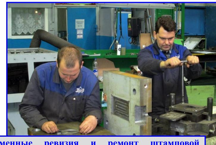
Своевременные ревизия и ремонт штамповой оснастки для обеспечения ритмичного производства и изготовления деталей по партиям запуска.
