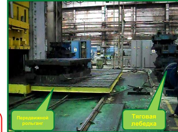
Внедрен передвижной рольганг с тяговой лебедкой. Сокращено время использования ГПМ при переналадке пресса на 40 мин. Снижен риск получения травм при работе с ГПМ. Исключена вероятность простоя пресса при ремонтных работах на ГПМ.
