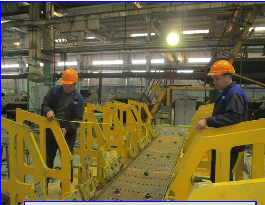
Проектирование, изготовление, монтаж и нивелировка сложной, крупногабаритной оснастки закладочного стенда с последующим техническим обслуживанием.
