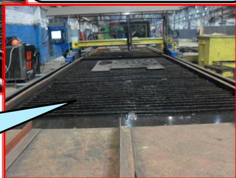
Изготовление и установка стола для машины термической резки «Термит» своими силами составляет 300 тыс. руб.
